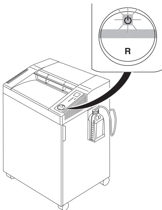
تتوقف الماكينة عن العمل اوتوماتيكا عند عدم وجود ورق
