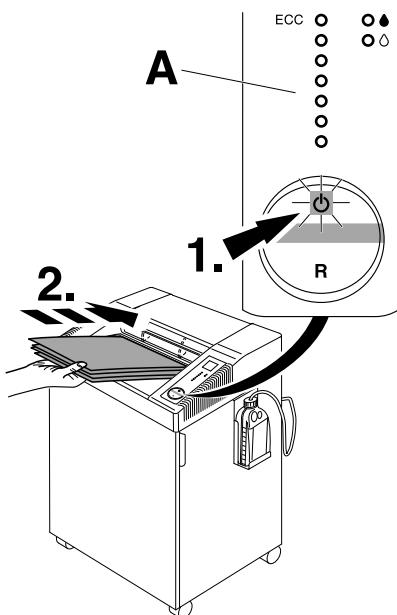
**NL** Schakelaar indrukken (1.) : groen licht gaat aan, machine is bedrijfsklaar. Start automatisch zodra papier wordt ingevoerd (2.). Automatische standby schakelt naar 15 minuten uit. De machine kan op elk gewenst moment worden uitgeschakeld door op de knop te drukken. Groene LED controlelampje is uit. De machine verbruikt dan geen stroom meer.
