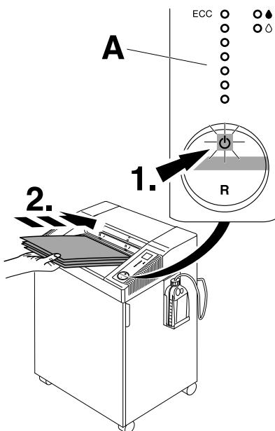
**DE** Schalter drücken (1.) : grünes Licht leuchtet, Maschine betriebsbereit. Autom. Anlauf bei Papierzufuhr (2.). Autom. Standby - Abschaltung nach 15 Minuten. Maschine kann jederzeit durch Drücken des Schalters ausgeschaltet werden. Grüne Kontrollleuchte erlischt. Danach verbraucht die Maschine keinen Strom mehr. **Alle Maschinen haben eine ECC-Anzeige (Electronic Capacity Control)** zur Leistungsanzeige beim Vernichten des Papiers (A).
