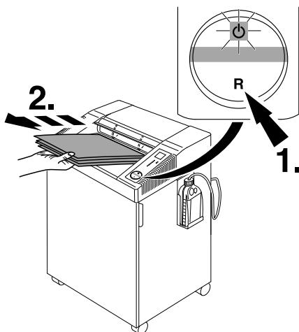
**DE Bei Bedarf:** Schalter "R" drücken, Papier entnehmen. (Maschine läuft nur kurz rückwärts, bei Bedarf mehrmals wiederholen).
