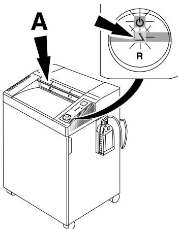
**NL** Automatische stop als de veiligheidsklep (A) geopend wordt (Symbolen ↴ en ⚡ knipperen afwisselend.)
