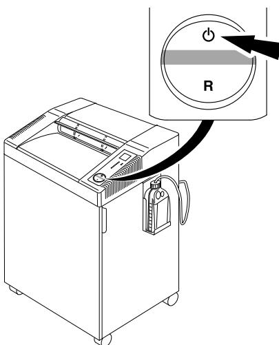
**NL** Automatische standby schakelt naar 15 minuten uit. De machine kan op elk gewenst moment worden uitgeschakeld door op de  $\odot$  knop te drukken. Groene LED controlelampje is uit. De machine verbruikt dan geen stroom meer. Binnen deze 15 minuten gebruikt de papiervernietiger de volgende energie:
