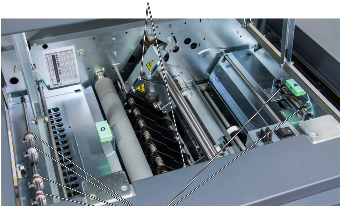
Protecciones de las cuchillas
